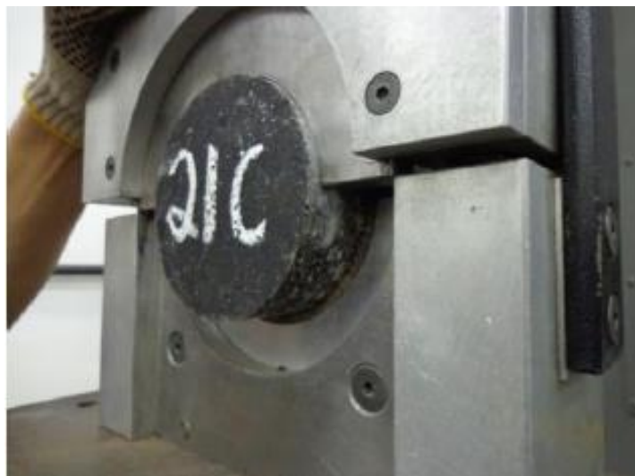
Figura 34 – Dispositivo do Ensaio Leutner.
