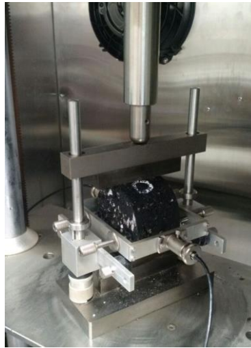
Figura 30 – Realização do ensaio para determinar o módulo de resiliência.
