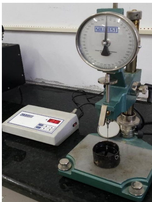
Figura 27 - Ensaio de penetração sendo executado
