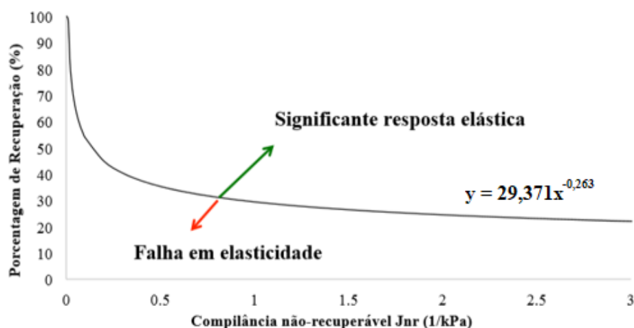
Figura 12 - Curva limite entre zonas de baixa e alta elasticidade de ligantes asfálticos
