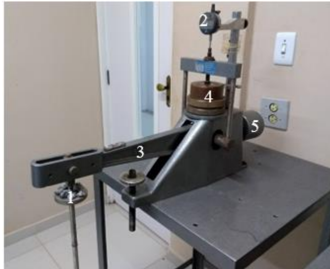
1-Carga de 10 kPa; 2-Reógió comparador; 3-Braço de alavanca com nível de bolha; 4-Celula de adensamento; 5-Contra-peso
