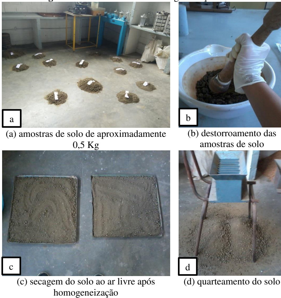
Figura 14. Procedimento de homogeneização do solo
