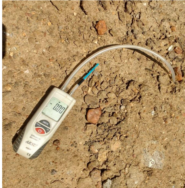
Figura 25. Monitoramento da pressão diferencial na interface solo-resíduo
