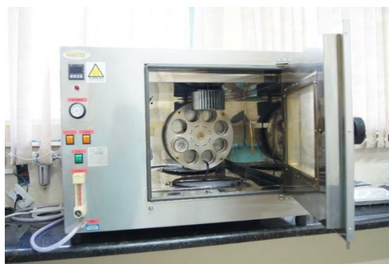
Figura 5 - Equipamento do RTFO (LEP/UFCG)
