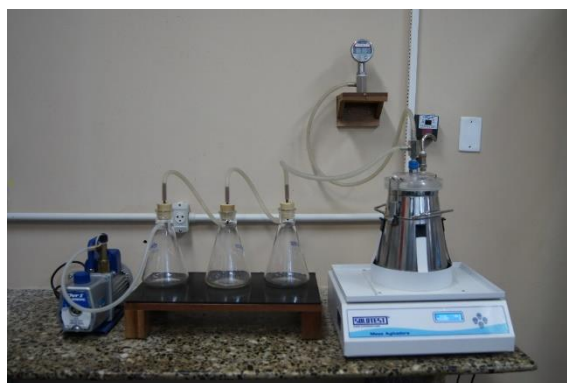
Figura 16 - Equipamento para ensaio de determinação do Gmm (Rice Test – LEP/UFCG)
