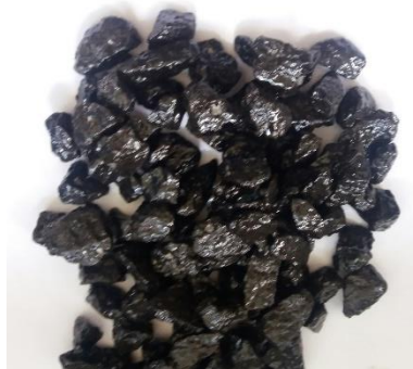
Figura 11 - Etapa da avaliação visual do ensaio de adesividade
