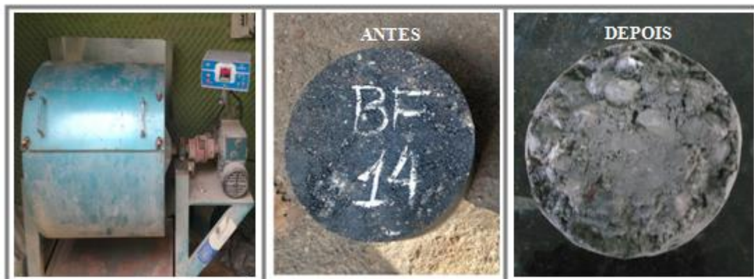
Figura 37 - Equipamento utilizado e aspecto do corpo de prova antes e após realização do ensaio de Cântabro.
