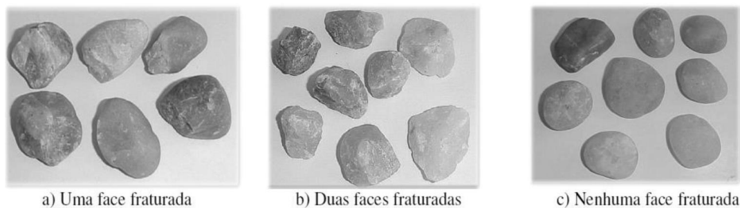
Figura 2 - Ensaio de porcentagem de partículas fraturadas
