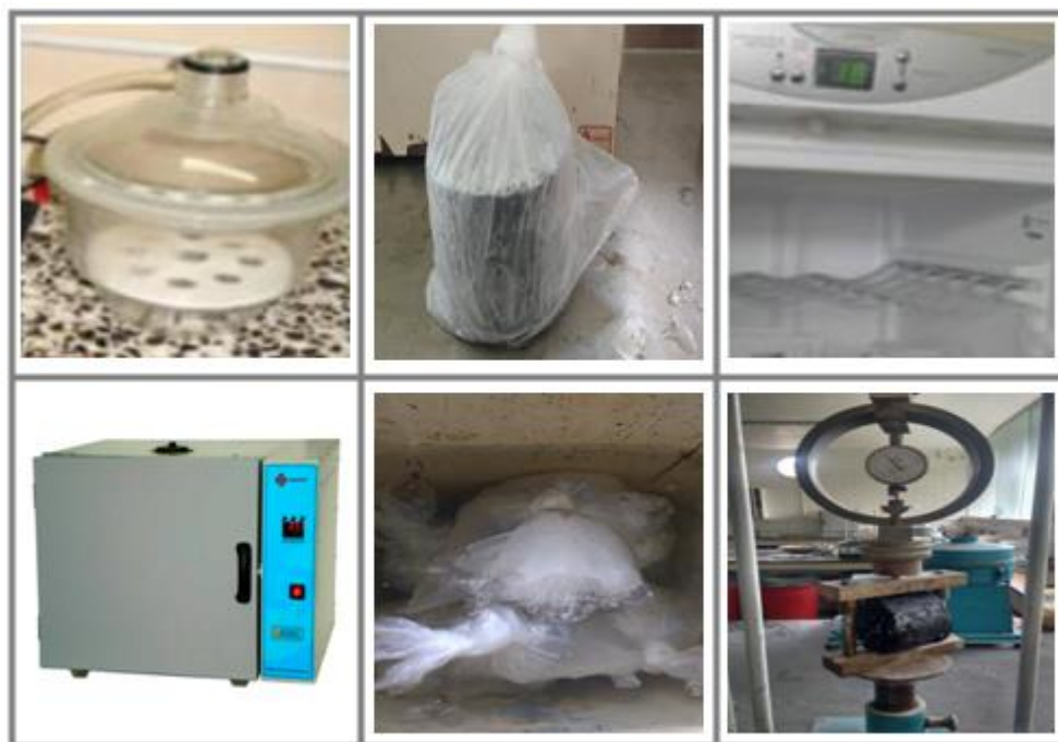
Figura 36 - Procedimento do ensaio de Lottman modificado.
