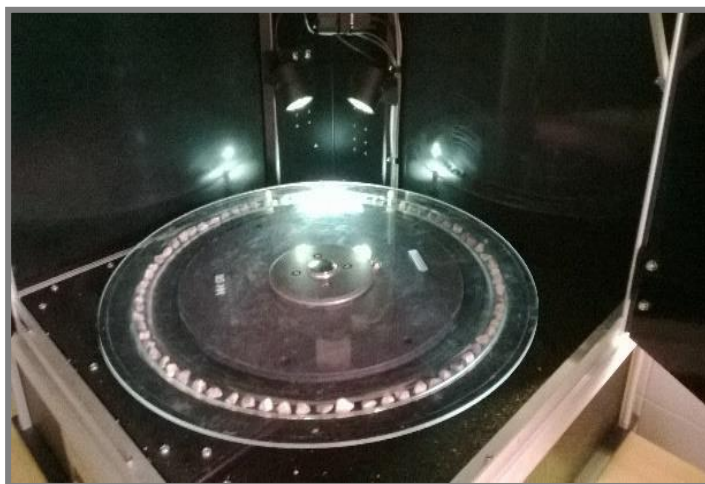
Figura 25 – Partículas posicionadas na bandeja do equipamento para realização do ensaio.
