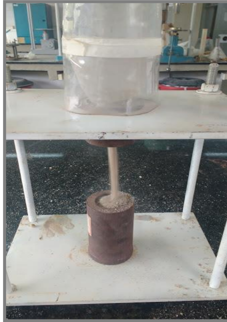
Figura 23 - Equipamento utilizado para realização do ensaio de angularidade.
