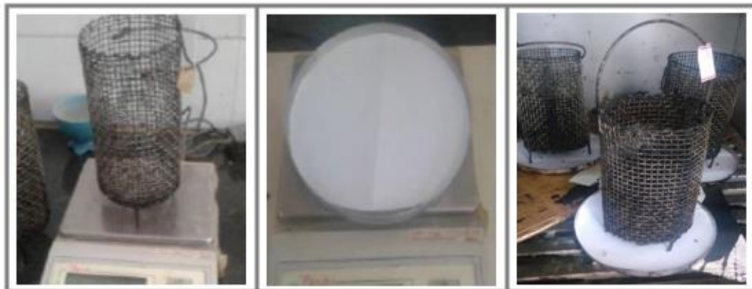
Figura 31 - Procedimentos de realização do ensaio de escorrimento.
