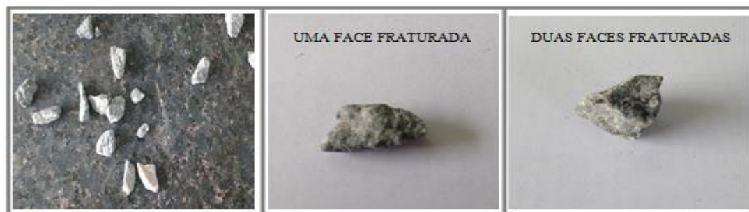
Figura 22 - Ensaio de partículas fraturadas (exemplos).
