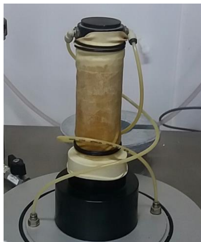
Figura 23: Corpo de prova protegido por membrana de látex
