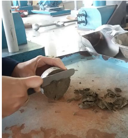
Figura 18: Modelagem das amostras para ensaio de curva característica.
