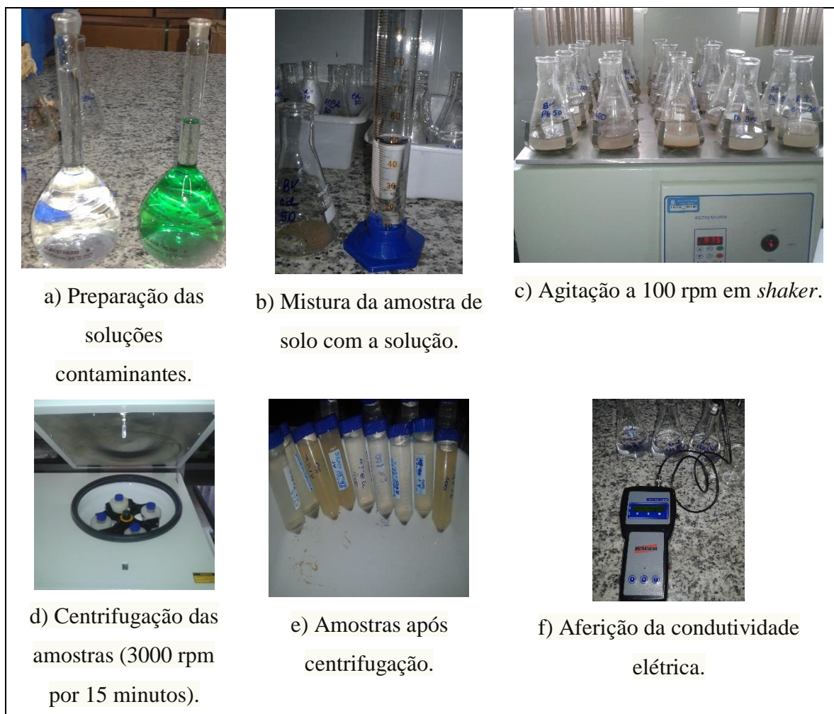
Figura 16-Sequência da execução do ensaio de equilíbrio em lote.
