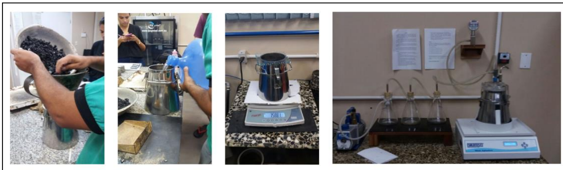
Figura 32 - Procedimento do ensaio para determinação da Gmm
