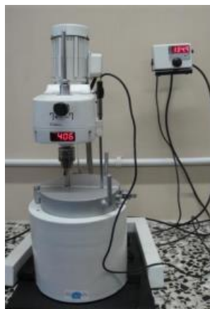
Figura 21 - Agitador mecânico FISATOM
