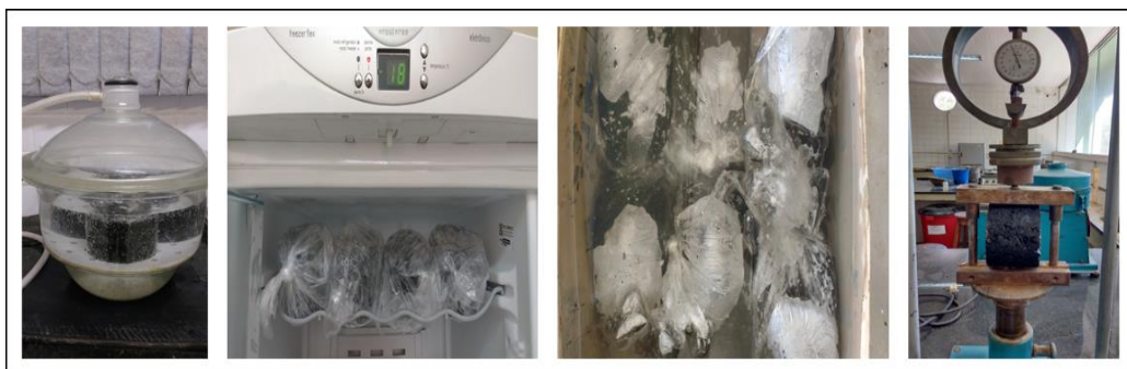
Figura 38: Procedimentos do ensaio de Lottman modificado
