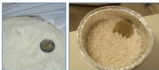
Figura 5 - Sasobit em flocos e em pastilha, respectivamente
