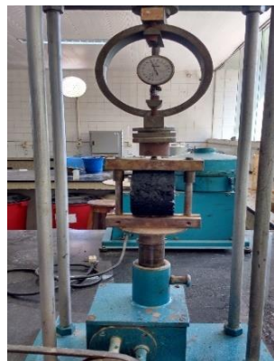
Figura 36 - Prensa do ensaio de Resistência à Tração
