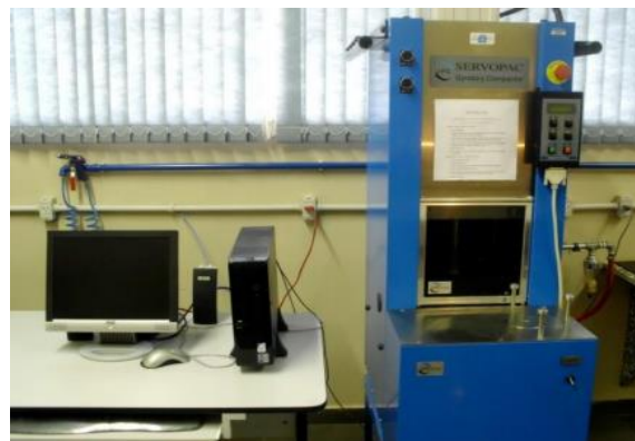
Figura 28 - Compactador Giratório SUPERPAVE
