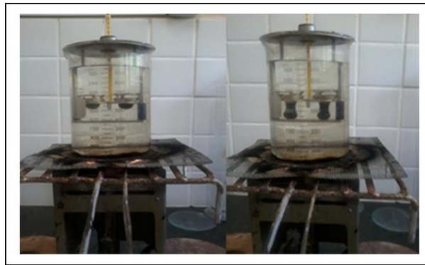
Figura 24 - Realização do ensaio de ponto de amolecimento
