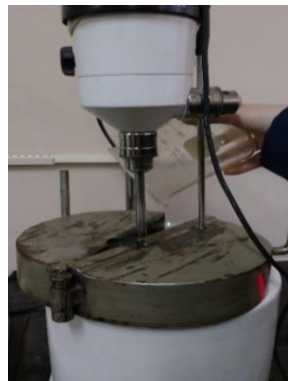
Figura 22 - Inserção do óleo de girassol ao ligante no misturador
