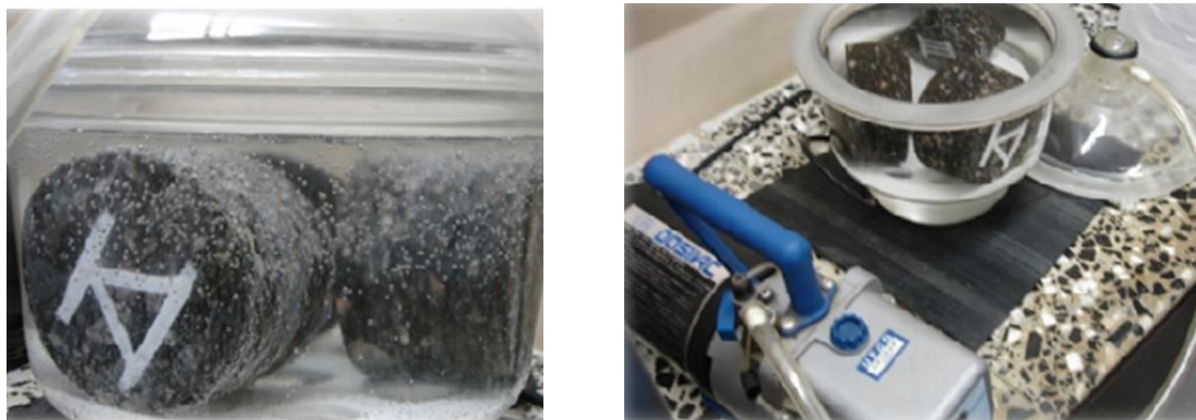
Figura 19 – Etapas do ensaio de Lottman modificado.
