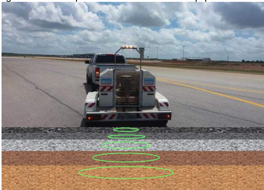
Figura 30 – Princípio de funcionamento do equipamento FWD.
