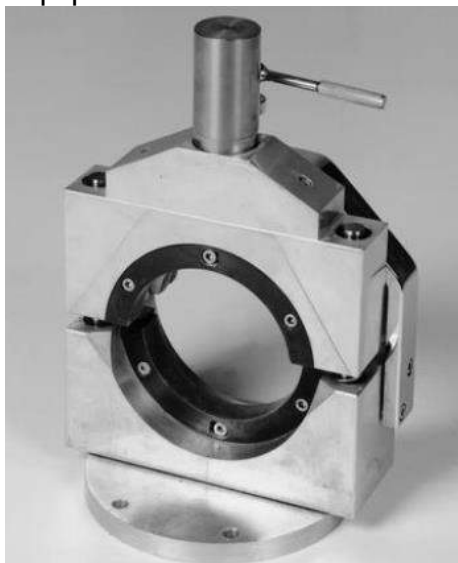
Figura 10 – Equipamento do ensaio Leutner Shear Test .
