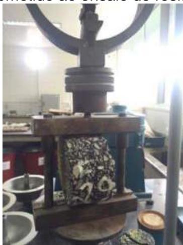
Figura 34 – CP F29 submetido ao ensaio de resistência a tração indireta.
