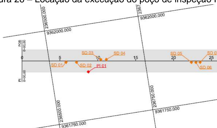
Figura 26 – Locação da execução do poço de inspeção PI 01.
