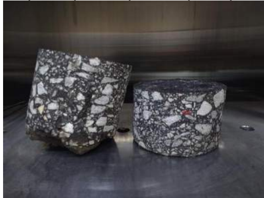
Figura 36 – Corpo de prova após a ruptura por cisalhamento.
