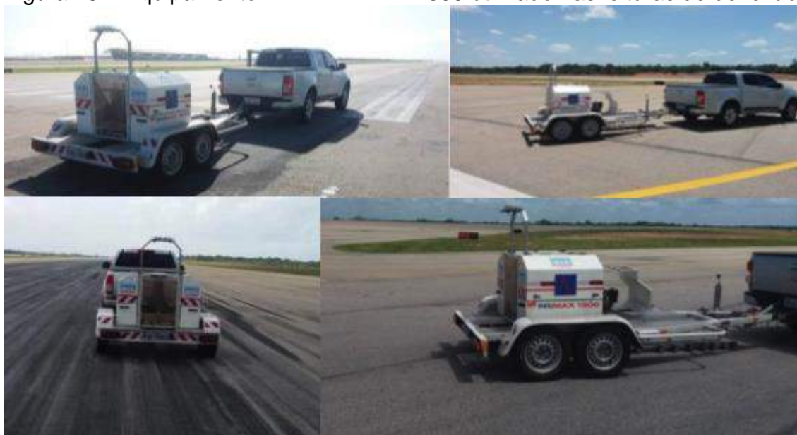
Figura 29 – Equipamento FWD PRIMAX 1500 utilizado nas leituras de deflexão.
