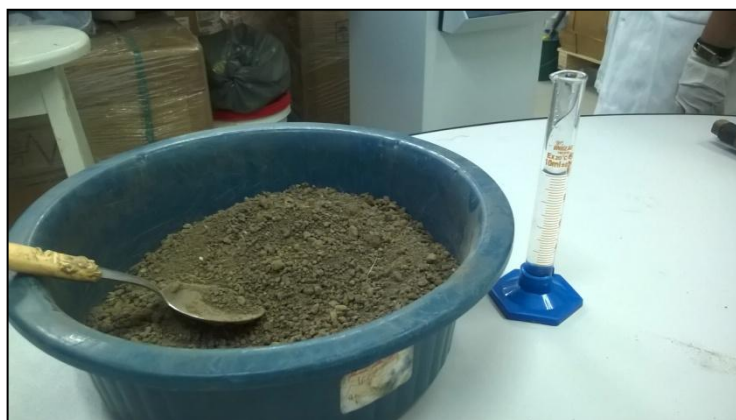
Figura 39 - Solo para calibração dos sensores de umidade.
