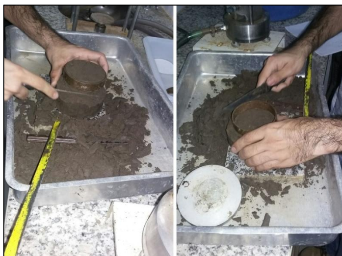
Figura 32 - Moldagem de amostras para ensaio de sucção.
