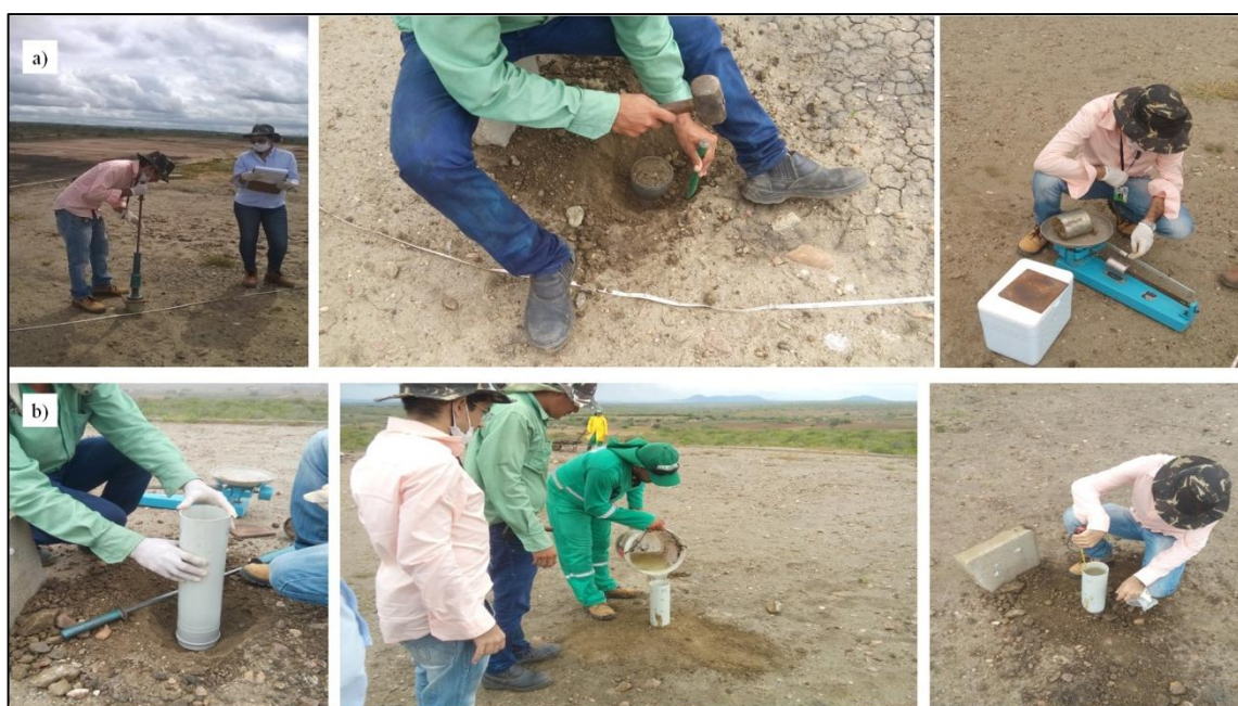
Figura 28 - Ensaios de campo no aterro sanitário: a) Cilindro de cravação, b) Infiltração.
