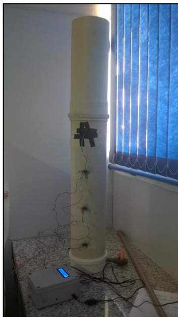
Figura 44 - Complemento de tubo adicionado para inundação da célula experimental.
