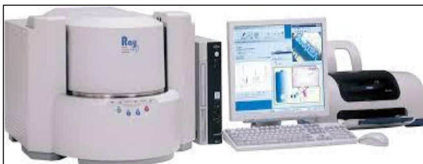
Figura 29 - Equipamento de análise mineralógica por Fluorescência de Raios-X (EDX).
