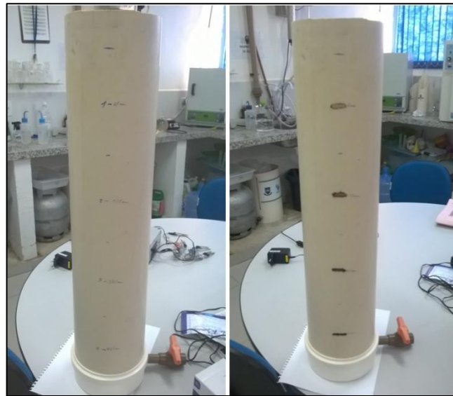
Figura 43 - Posicionamento dos sensores na célula experimental.
