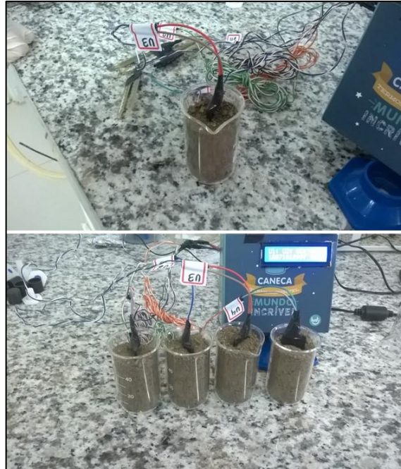
Figura 40 - Procedimento de aferição da umidade do solo.
