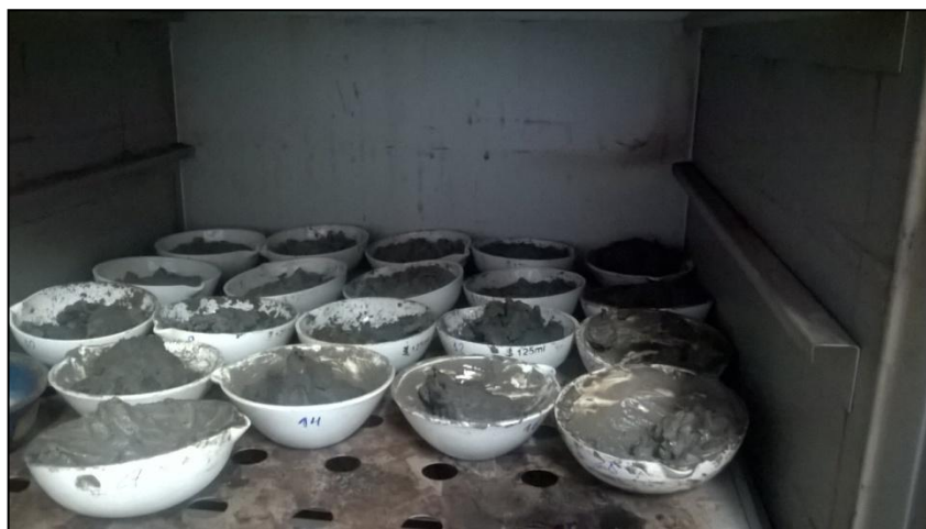
Figura 41 - Verificação da umidade do solo pelo método da estufa.
