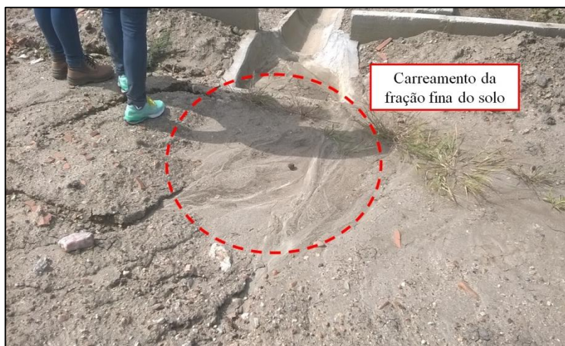
Figura 54 - Carreamento dos finos contidos no solo.
