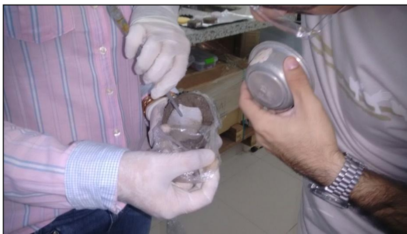
Figura 35 - Retirada do papel filtro das amostras.
