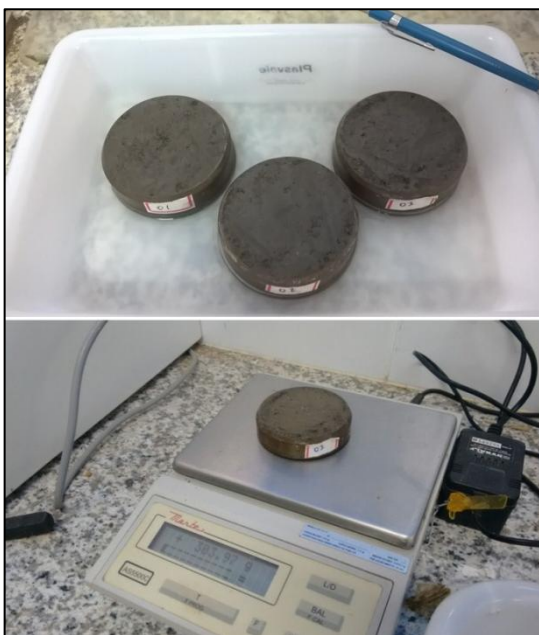
Figura 33 - Amostras com lâmina d'água e pesagem após período de saturação.
