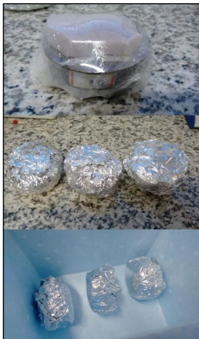
Figura 34 - Amostras envolvidas com filme plástico e acondicionadas.
