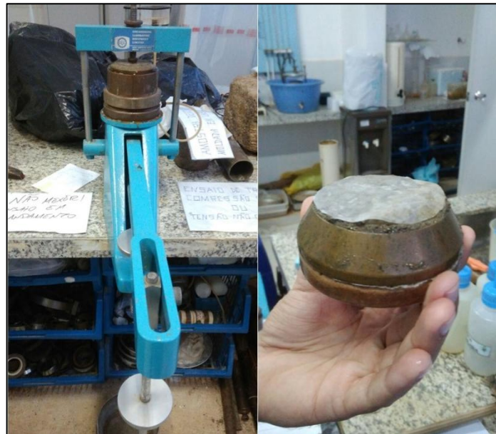
Figura 36 - Ensaio de índice de expansão do solo.
