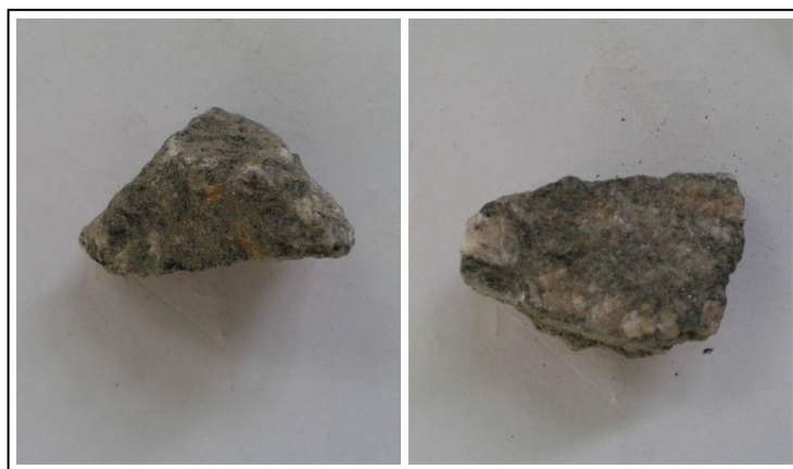
Figura 32: Partículas fraturadas da brita 19mm
