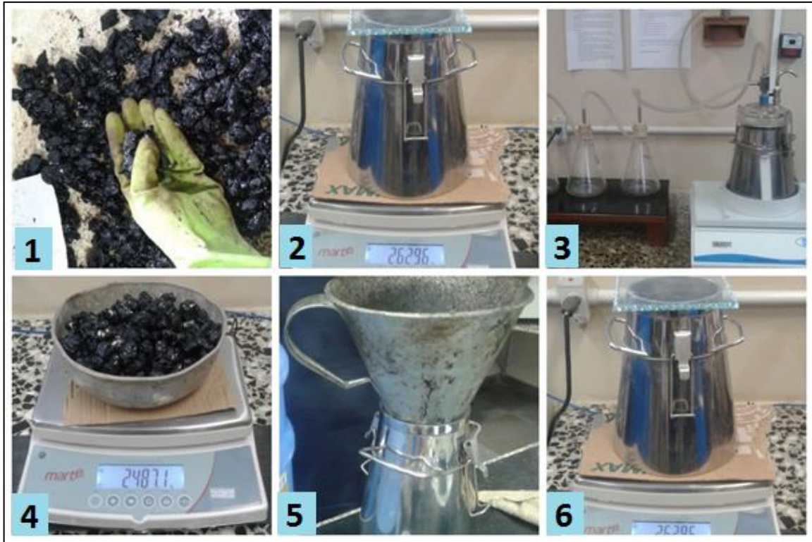
Figura 44: Sequência do Rice teste
