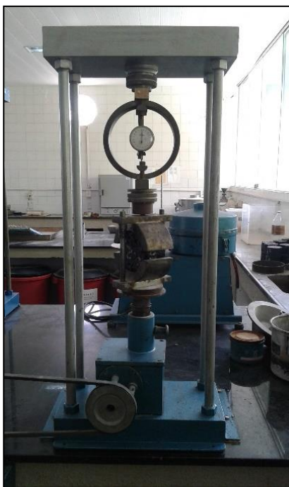
Figura 52: Ensaio de estabilidade Marshall
