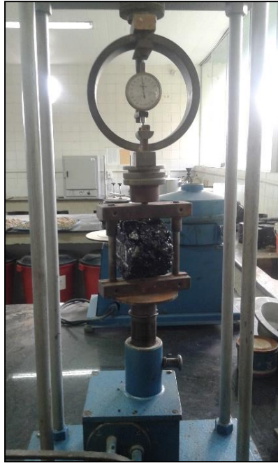
Figura 55: Ensaio de resistência à tração
