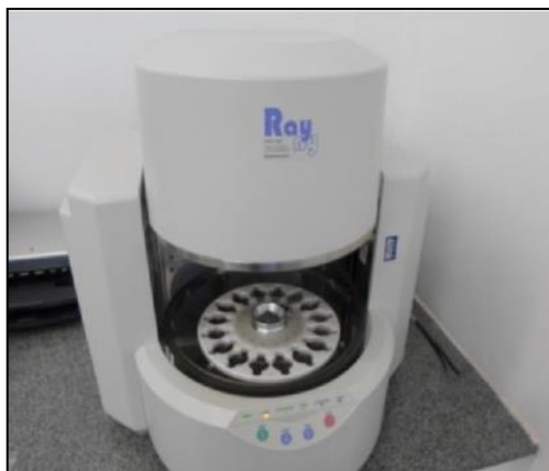
Figura 25: Equipamento EDX 720 da Shimadzu
