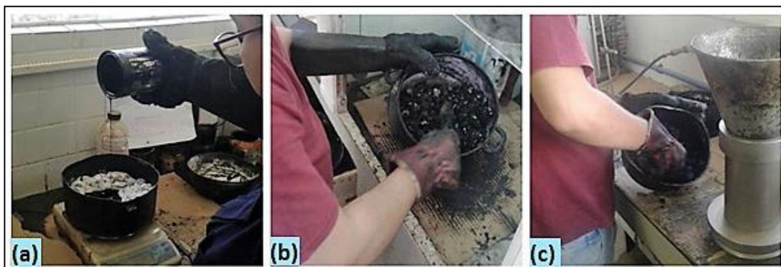
Figura 47: Procedimentos da etapa de mistura das SMAs avaliadas
