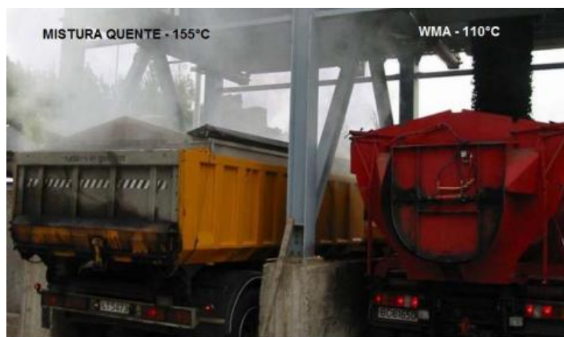
Figura 03 – Comparação entre misturas quente e morna recém produzidas (PROWELL E HURLEY, 2007)
