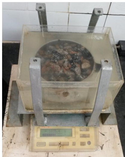
Figura 16 - Verificação da massa submersa da brita 19mm
