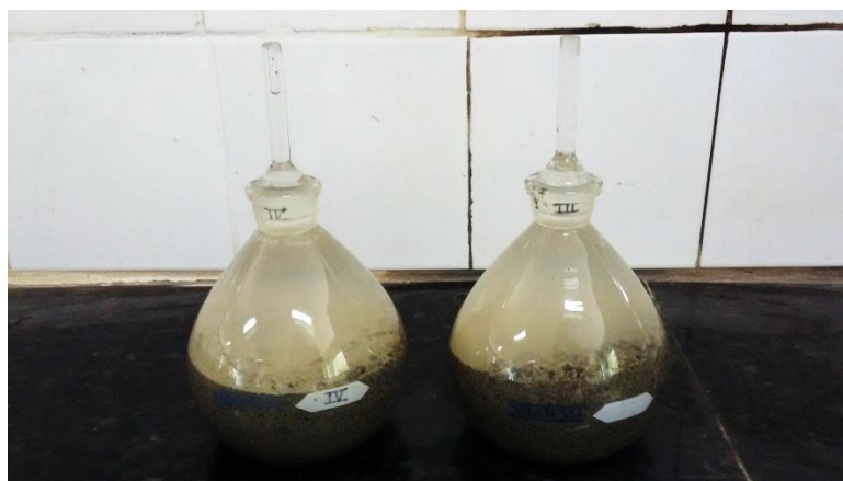
Figura 18 – Picnômetro com amostra e água
