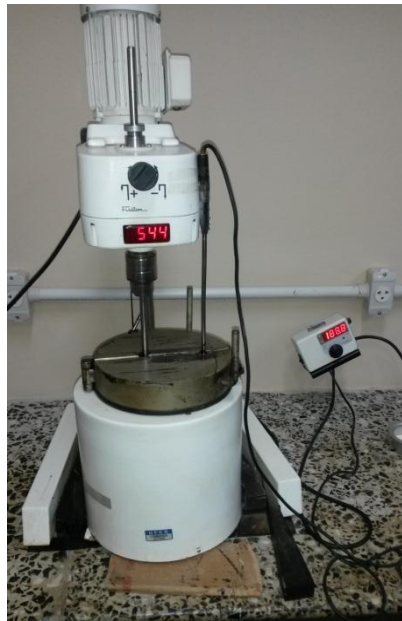
Figura 20 - Misturador (FISATOM, Modelo 72) com CAP e CCBIt
