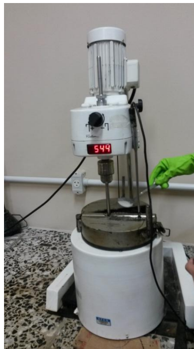
Figura 21 – Inserção do CCBIt no misturador com CAP
