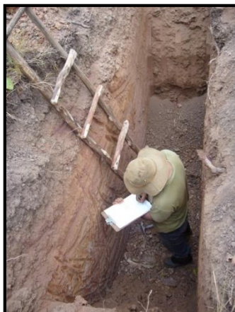
Figura 4: Trincheira de inspeção
