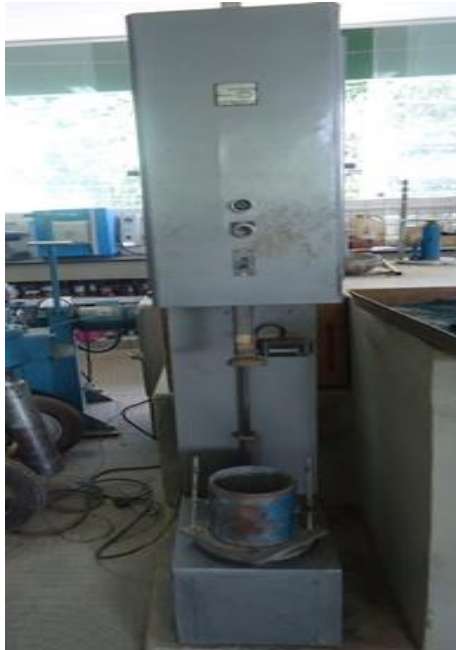
Figura 26 – Compactador mecânico utilizado na pesquisa.
