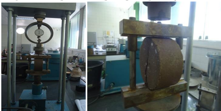
Figura 32 – Ruptura do corpo de prova por tração indireta.
