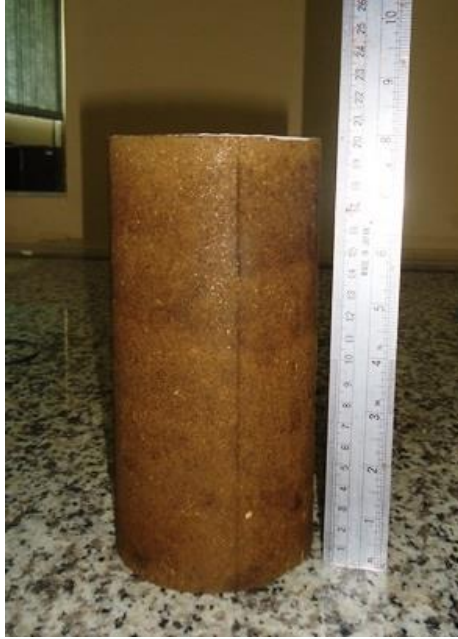
Figura 36 – Corpo de prova utilizado no ensaio de MR.
