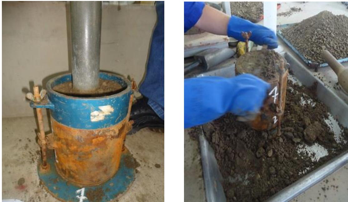
Figura 24 – Execução do ensaio de compactação manual.
