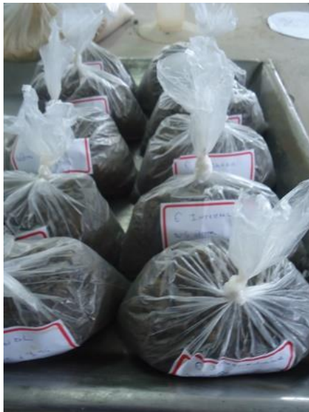
Figura 25 – Amostras de solo em processo de cura por 24 horas.
