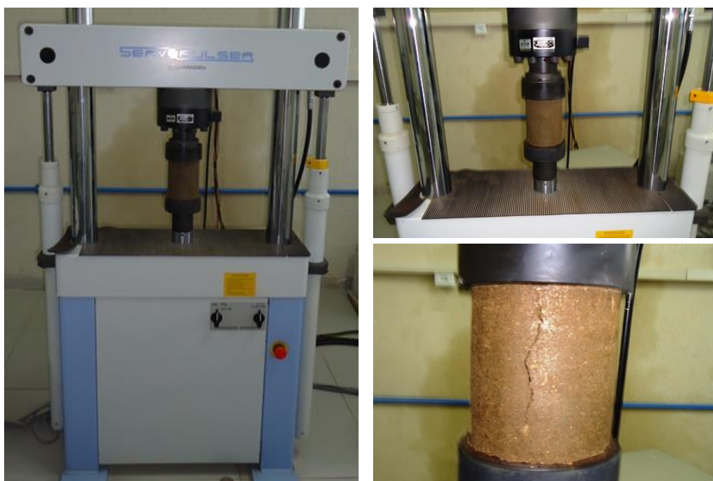
Figura 33 – (a) Prensa utilizada para RCS e (b) corpo de prova após execução do ensaio.
