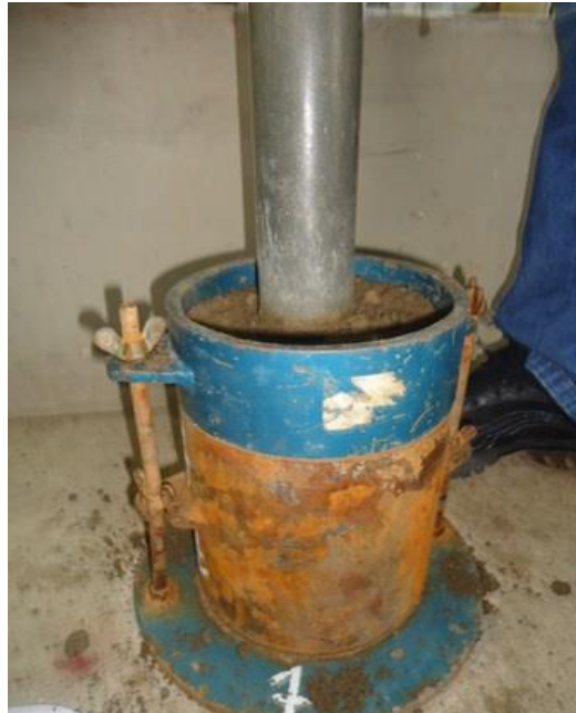
Figura 2 – Compactação Proctor por impacto de um solo.
