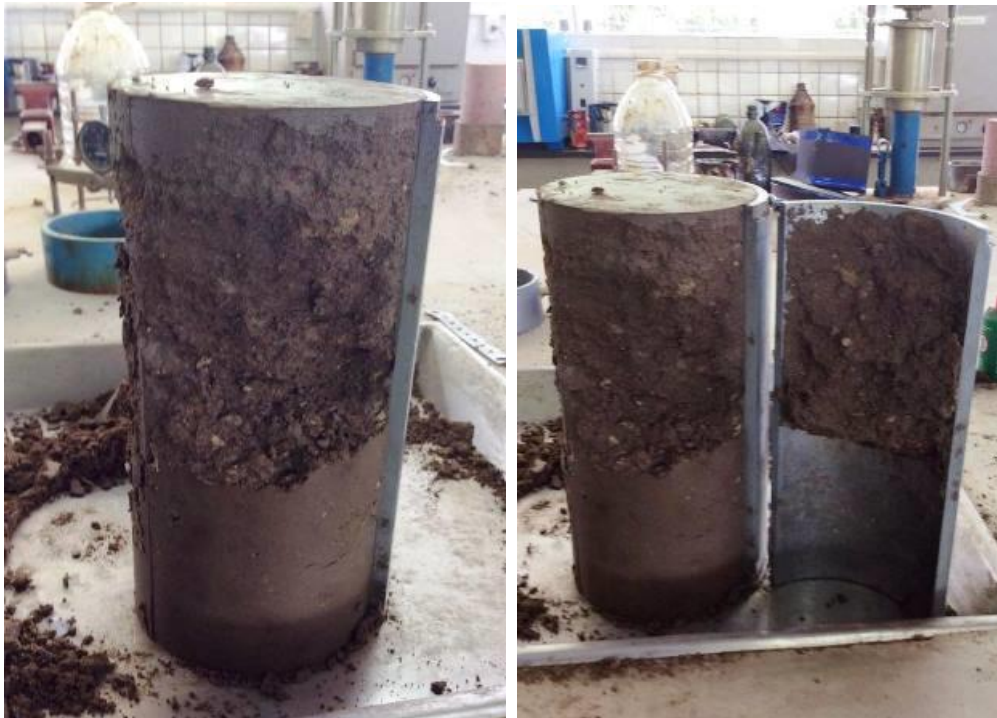
Figura 37 – Corpo de prova da compactação mecânica moldados em umidades superiores a Hótima.
