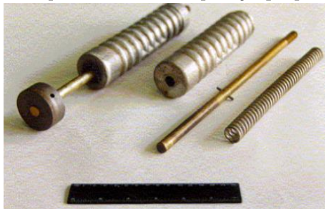
Figura 13 – Soquete utilizado na compactação por pisoteamento.
