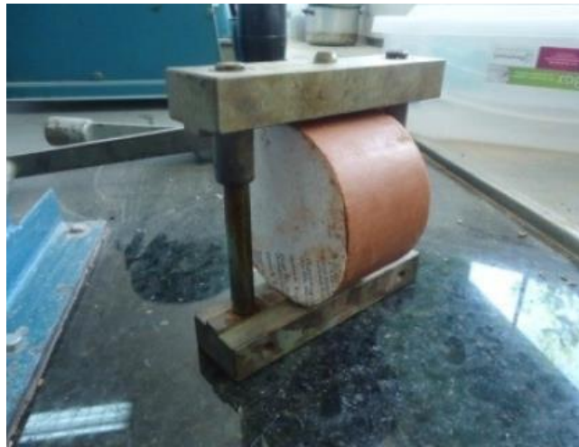
Figura 29 – Posicionamento do corpo de prova para ensaio de resistência à tração.
