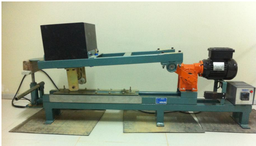
Figura 3.20 – Equipamento utilizado no ensaio de LWT
