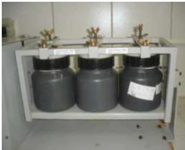
Figura 3.10 - Equipamento rotativo utilizado para execução do ensaio nesta pesquisa
