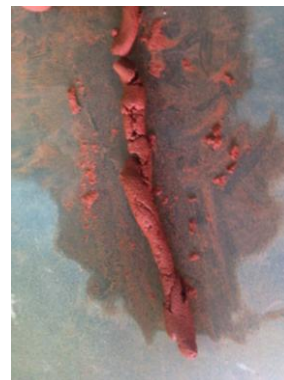
Figura 3.4 - Limite de liquidez (a) e plasticidade (b)
