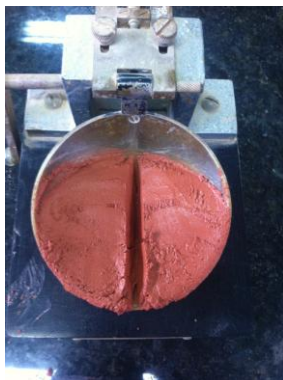
Figura 3.4 - Limite de liquidez (a) e plasticidade (b)
