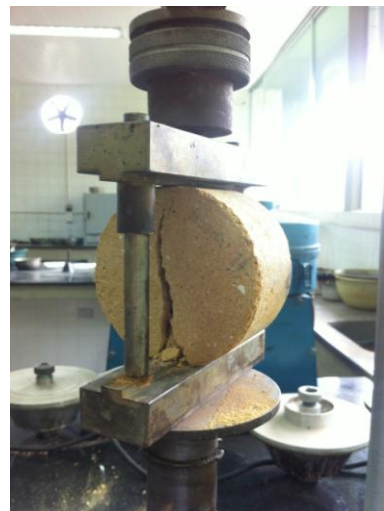
Figura 3.16 – Ruptura do corpo de prova por tração indireta
