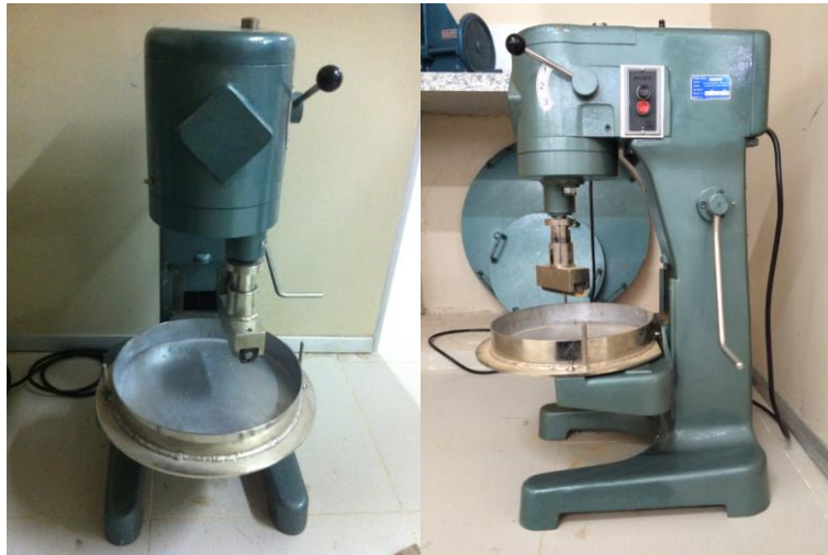
Figura 3.24 – Equipamento utilizado no ensaio de WTAT
