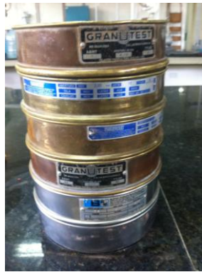
Figura 3.3 – Execução do ensaio de análise granulométrica
