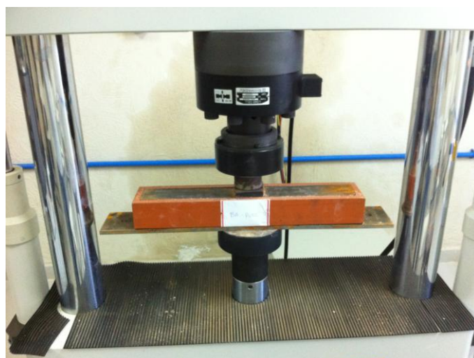
Figura 3.21 – Compactação do corpo de prova de LWT
