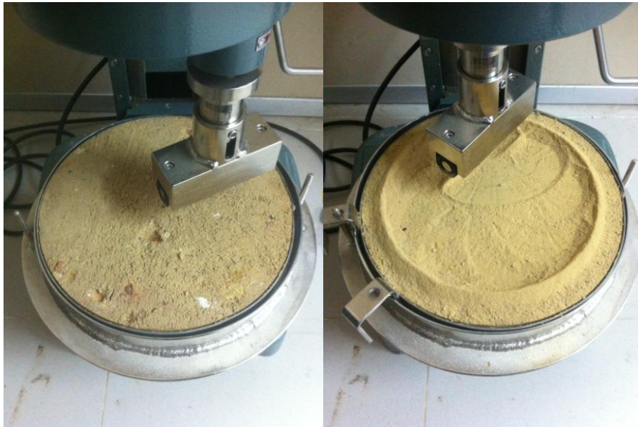
Figura 3.26 – Execução do ensaio de WTAT
