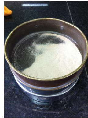
Figura 3.3 – Execução do ensaio de análise granulométrica
