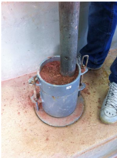
Figura 3.13 – Execução do ensaio de compactação
