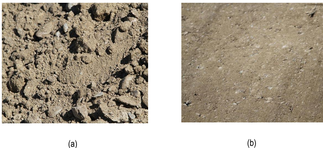
Figura 2.3 - Camada não tratada(a) e tratada(b) com polímero
