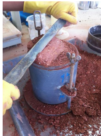
Figura 3.13 – Execução do ensaio de compactação
