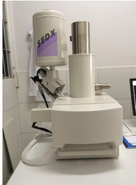
Figura 3.8 - Equipamento utilizado para realização do ensaio de MEV
