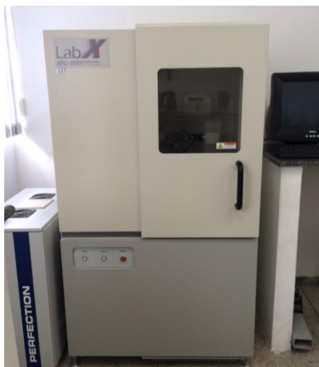
Figura 3.7 - Equipamentos utilizados para realização do ensaio de difração de raios-x nesta pesquisa
