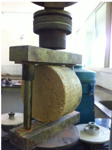
Figura 3.16 – Ruptura do corpo de prova por tração indireta
