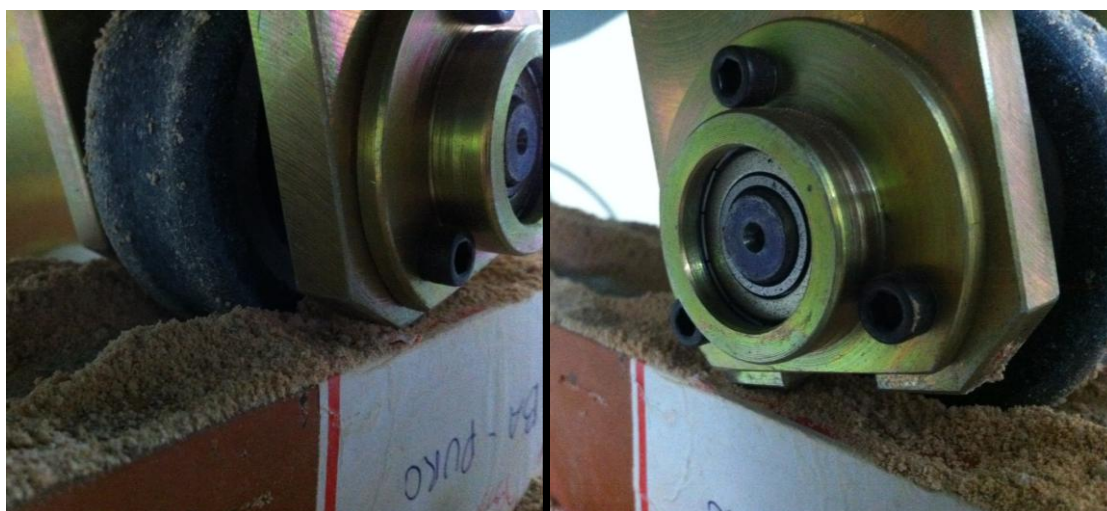
Figura 3.22- Critério de parada utilizado no ensaio de LWT
