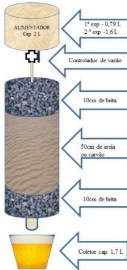
Figura 15 – Esquema de montagem das unidades de percolação.
