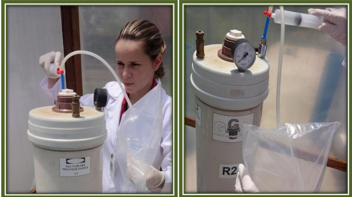
As leituras da concentração dos gases ( $\text{CH}_4$ ,  $\text{CO}_2$ ,  $\text{O}_2$ ,  $\text{H}_2\text{S}$  e  $\text{CO}$ ) foram realizadas pelo detector portátil e automático de gases com infravermelho Dräger modelo X-am 7000 (Figura 30).
