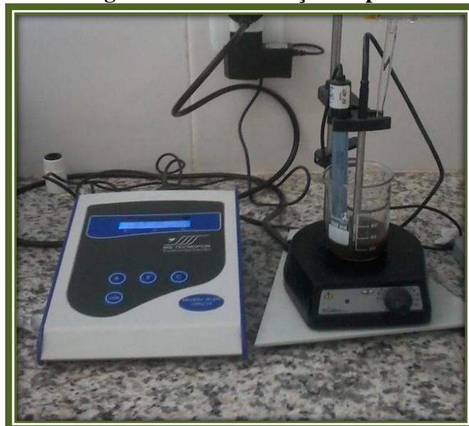
Para realização do ensaio adicionou-se em um béquer 25 ml de amostra de resíduos sólidos contida nos biorreatores, agitando-a levemente com o auxílio de um agitador magnético. Em seguida introduziu-se o eletrodo nessa amostra e, quando estabelecido o equilíbrio, fez-se a leitura do pH.
