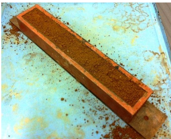
Figura 31 - Preparação e compactação corpo de prova para o ensaio LWT
