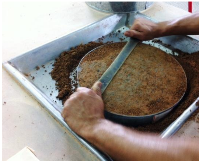
Figura 36 - Corpo de prova sendo nivelado
