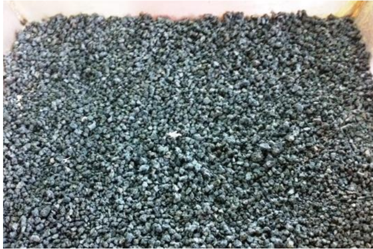
Figura 12 - Lodo seco em estufa e destorroado
