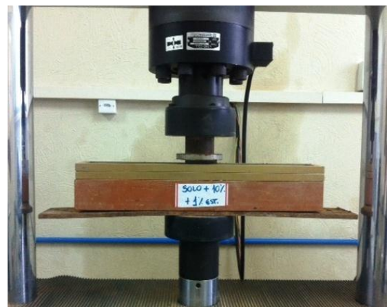
Figura 31 - Preparação e compactação corpo de prova para o ensaio LWT
