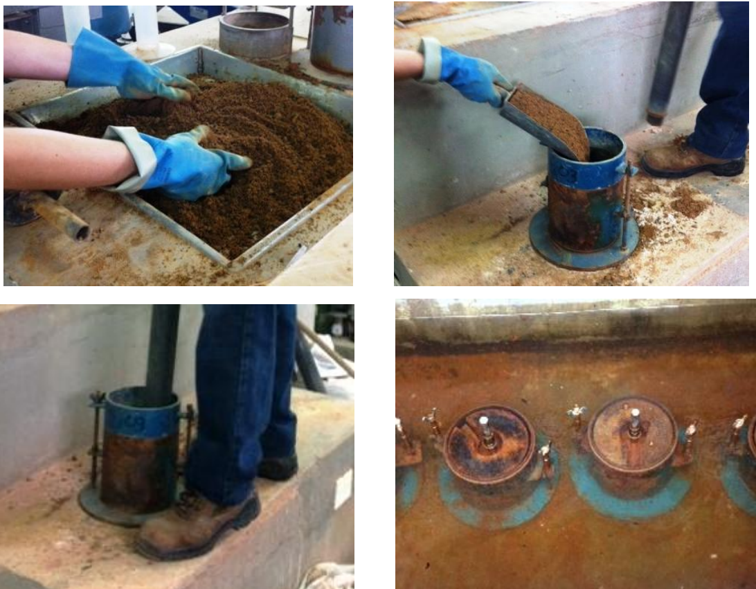
Figura 22 - Ensaio de ISC: mistura, moldagem e imersão
