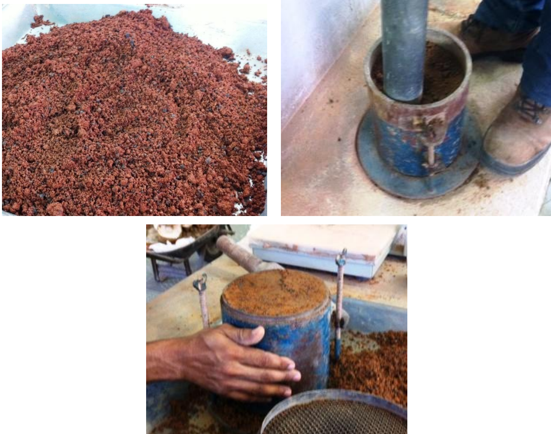
Figura 21 - Ensaio de Compactação: mistura, compactação e moldagem
