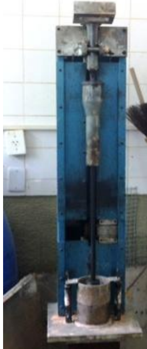
Figura 25 - Compactação do corpo de prova para o ensaio RT
