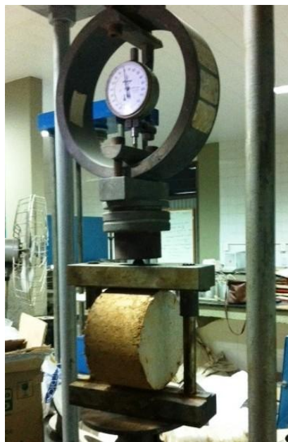
Figura 26 - Compactação corpo de prova para o ensaio RT
