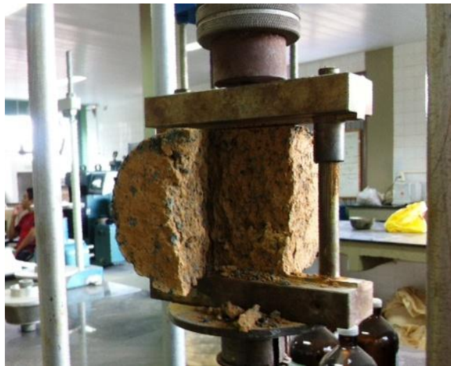
Figura 29 - Corpo de prova rompido RT
