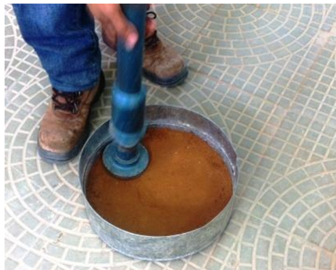
Figura 35 - Compactação corpos de prova WTAT
