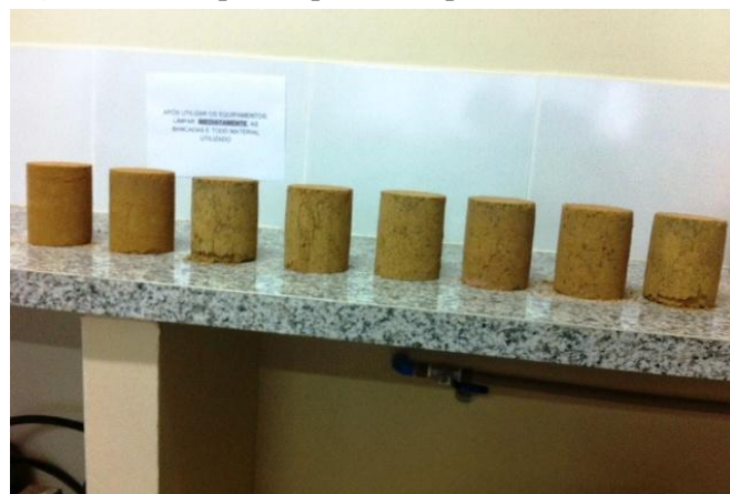
Figura 28 - Corpos de prova rompidos RCS
