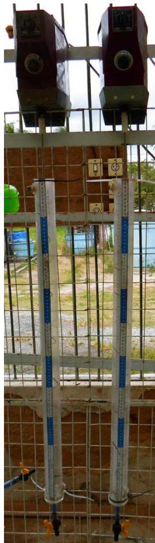
Figura 3.18: Representação visual das colunas de decantação na avaliação da intensidade de agitação.
