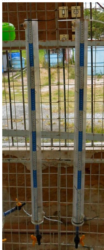
Figura 3.12: Representação visual das colunas de sedimentação utilizados no método estático
