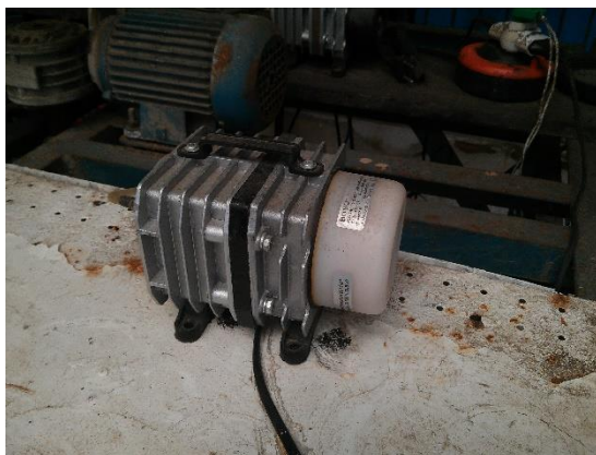
Figura 3.4: Aerador utilizado nos sistemas experimentais
