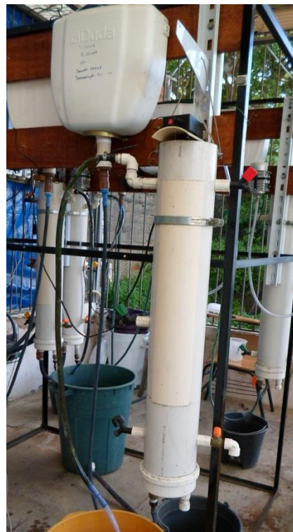
Figura 3.6: Foto do sistema RBS Unitário
