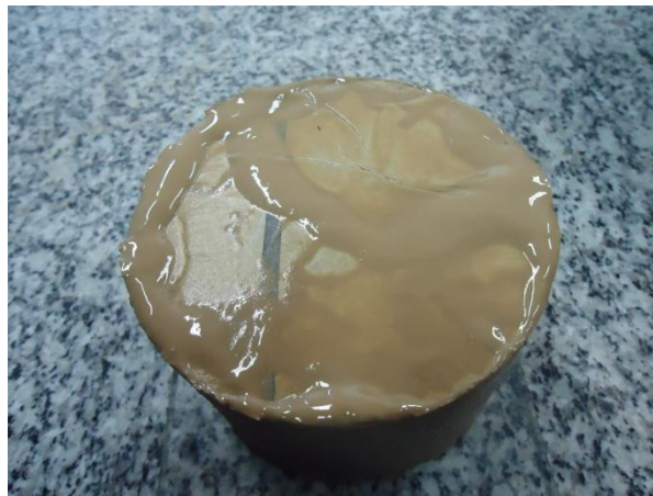
Figura 55 – Água acumulada no corpo de prova do solo 01 moldado no CGS.
