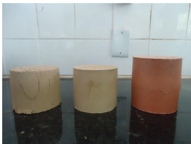
Figura 51 – Diferença de altura dos CPs moldados no CGS para o ensaio de RCS.
