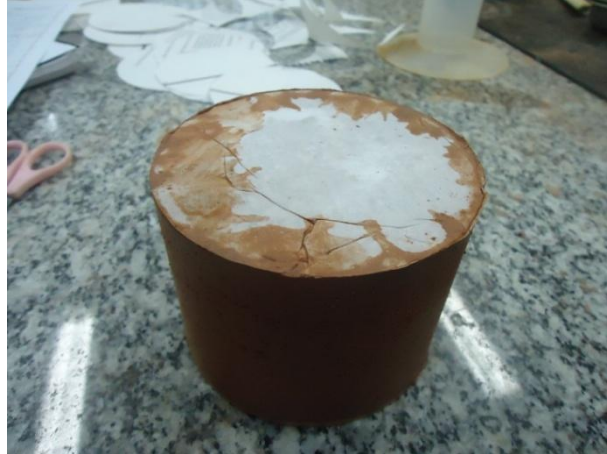
Figura 56 – Água acumulada no papel filtro depois da compactação no CGS.
