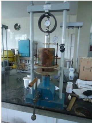
Figura 32 – (a) Prensa manual do ensaio de CBR, (b) Extensômetro e molde – equipamentos utilizados para realização dos ensaios de expansão e (c) Corpos de prova imersos no tanque.
