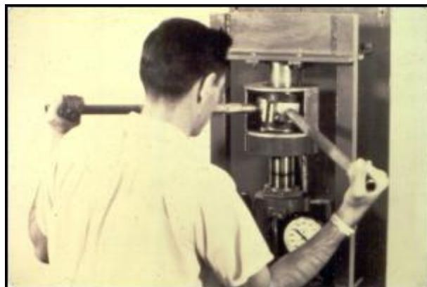
Figura 6 – Prensa giratória do Texas (HARMAN et. al., 2002).
