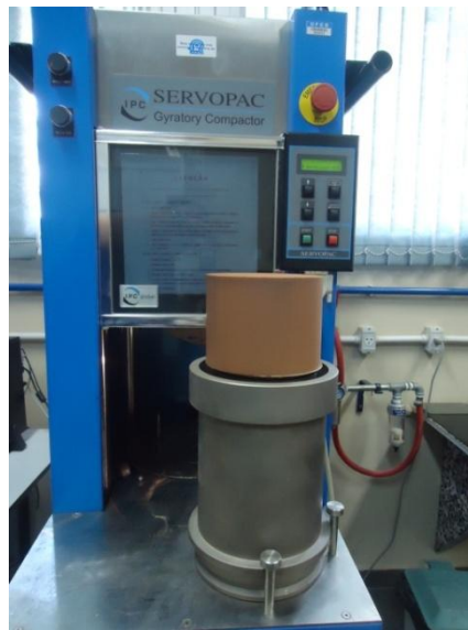
Figura 33 – CP desmoldado após a compactação no CGS para utilização no ensaio CBR.
