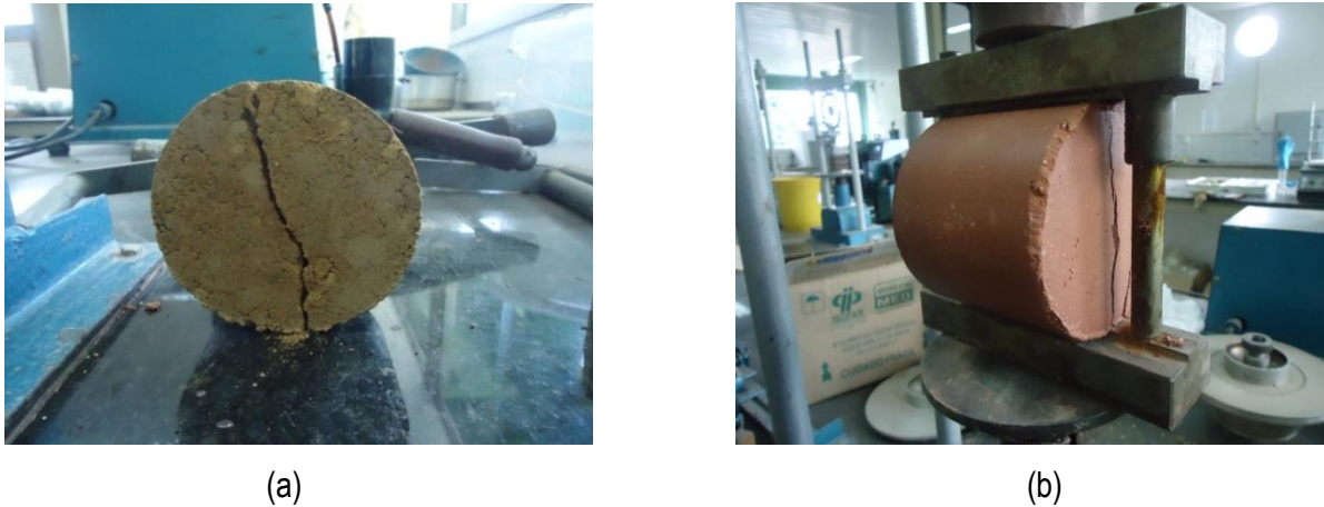
Figura 49 – Ruptura sofrida nos CPs para o (a) solo 02 e (b) solo 03 durante o ensaio de RTCD.
