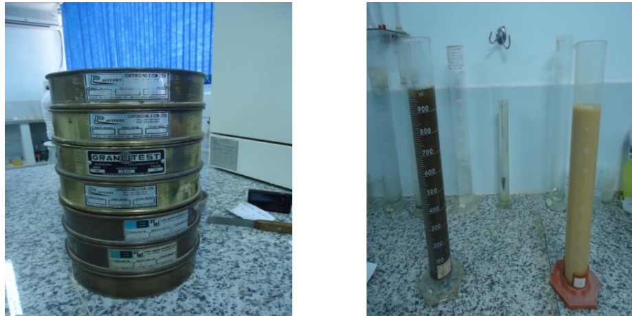
Figura 25 – (a) Série-padrão de peneiras para o ensaio de granulometria por peneiramento e (b) Provetas com solos mais solução para ensaio de granulometria por sedimentação.
