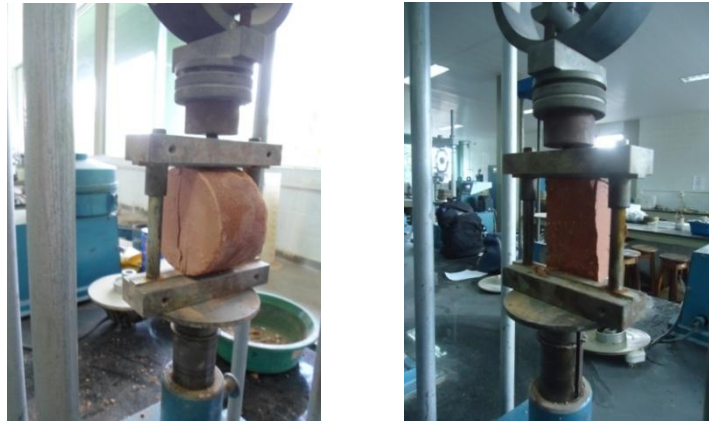
Figura 37 - Ruptura do corpo de prova RTCD
