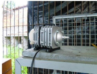
Figura 3.4 : Aeradores utilizados nos sistemas
