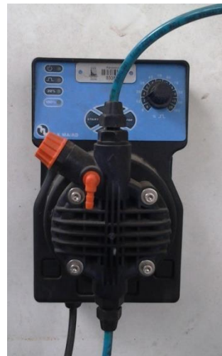
Figura 3.3: Bomba dosadora para alimentação do UCT
