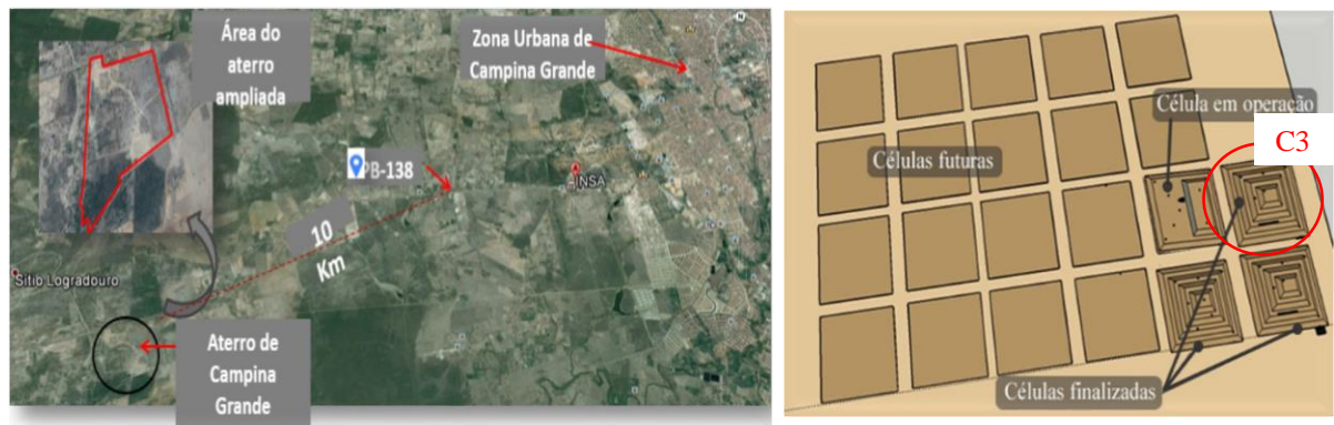
Figura 1 – Aterro Sanitário em Campina Grande (PB): 1A) Localização; 1B) Layout do Aterro
