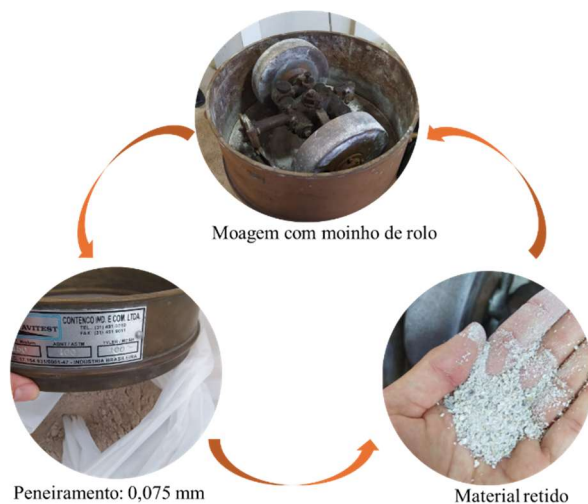
Figura 28. Procedimento de moagem das conchas de marisco utilizando moinho de rolo
