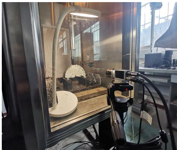
Figura 50: Sistema de carregamento de teste SCB gravado por câmera digital industrial CMOS.
