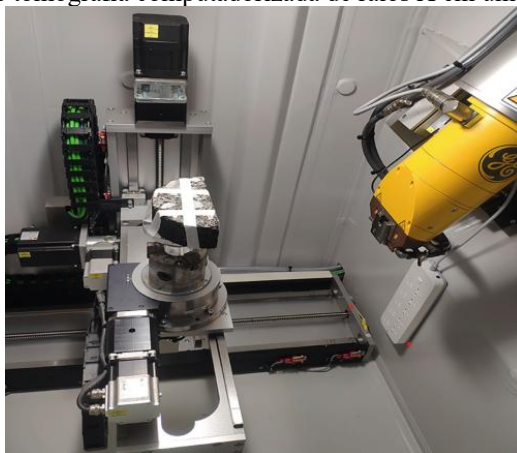
Figura 48: Ensaio de tomografia computadorizada de raios X em um corpo de prova SCB.
