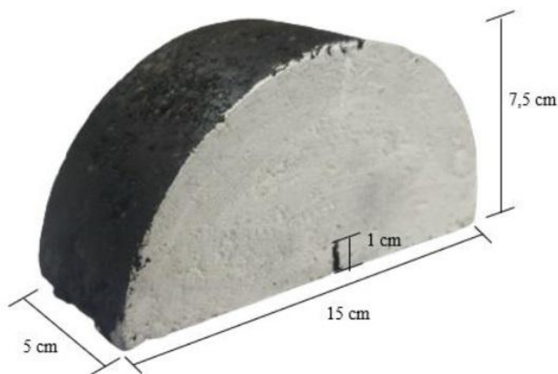
Figura 49: Amostra SCB com uma das faces pintada na cor branca.
