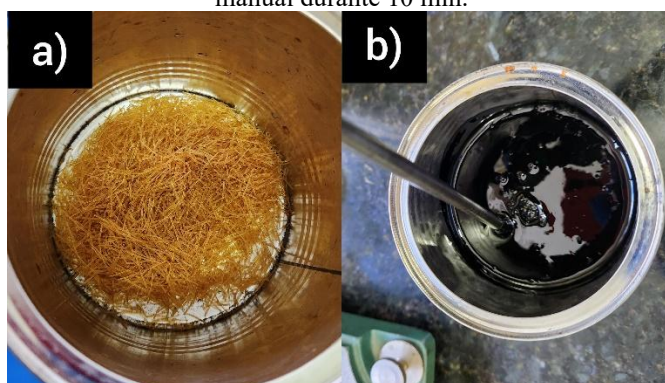
Figura 46: a) adição de 5% de fibras ao recipiente no qual efetuou-se a modificação do ligante; b) mistura manual durante 10 min.
