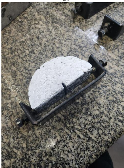
Figura 51: Corpo de prova posicionado no molde metálico para um período de descanso de 4 h em estufa à 40 °C.
