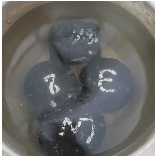
Figura 21: Corpos de prova em banho-maria a 60°C.
