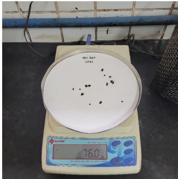
Figura 14:Material resultante do escorrimento do cesto.
