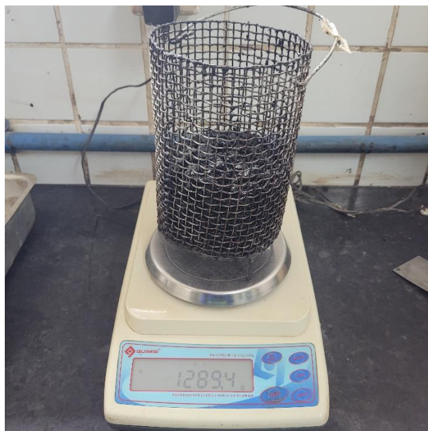
Figura 13: Amostra acomodada no cesto para determinação da porcentagem de escorrimento.
