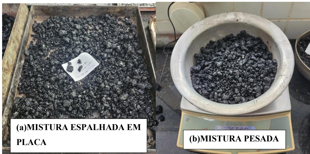
Figura 9: Determinação da densidade máxima da mistura pelo Rice Test.
