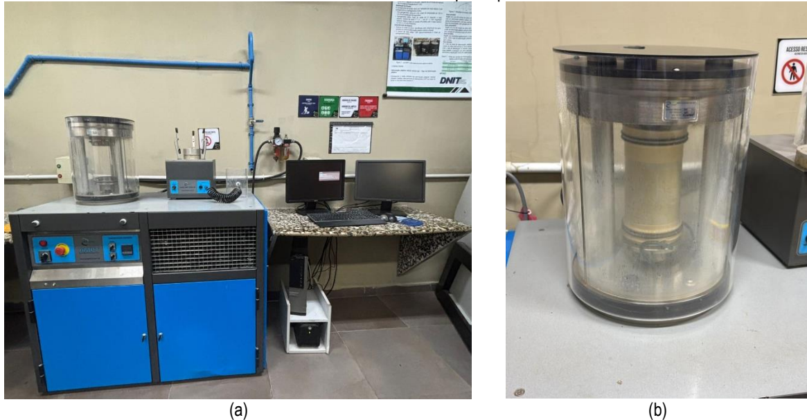
Figura 37: Condicionamento do corpo de prova para o ensaio de SSR na AMPT (a): Equipamento AMPT; (b): Condicionamento do corpo de prova
