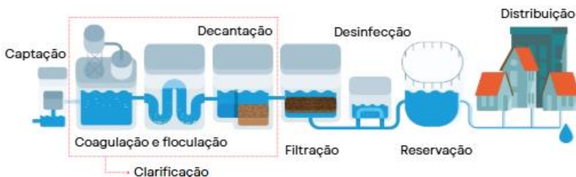
Figura 1: Etapas do tratamento convencional em ETA
