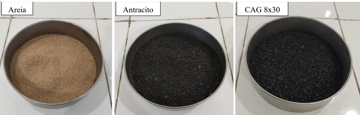
Figura 8: Materiais utilizados como leito filtrante: a) areia; b) antracito e c) CAG 8x30
