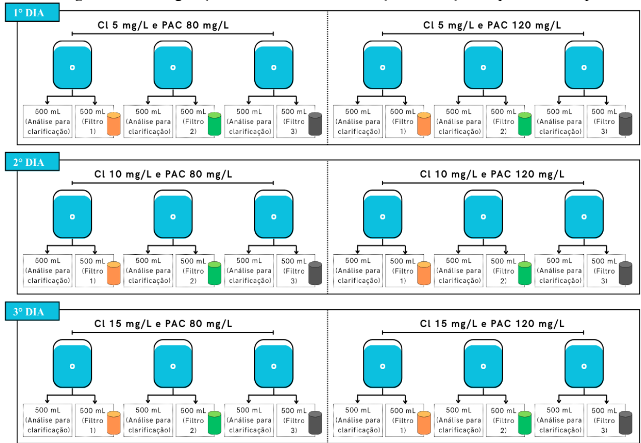
Figura 12: Configuração dos ensaios de clarificação e filtração na primeira campanha
