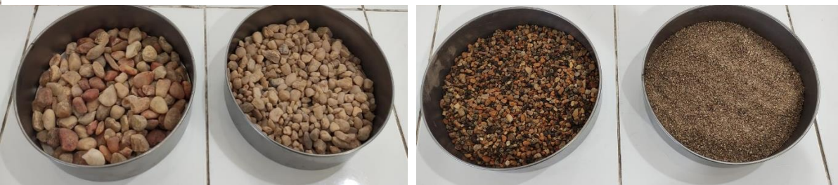
Figura 7: Seixos de diferentes granulometrias utilizados como camada suporte
