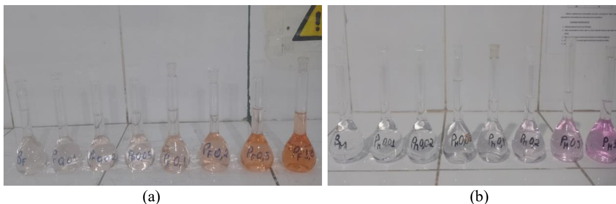
Figura 11: Padrões utilizados nos ensaios para a) ferro e b) manganês
