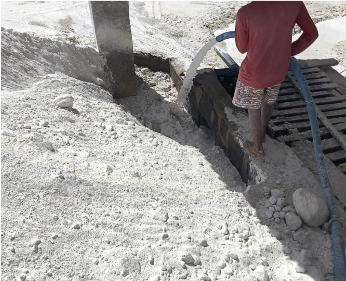
Figura 3: Lavagem do material para o moinho giratório
