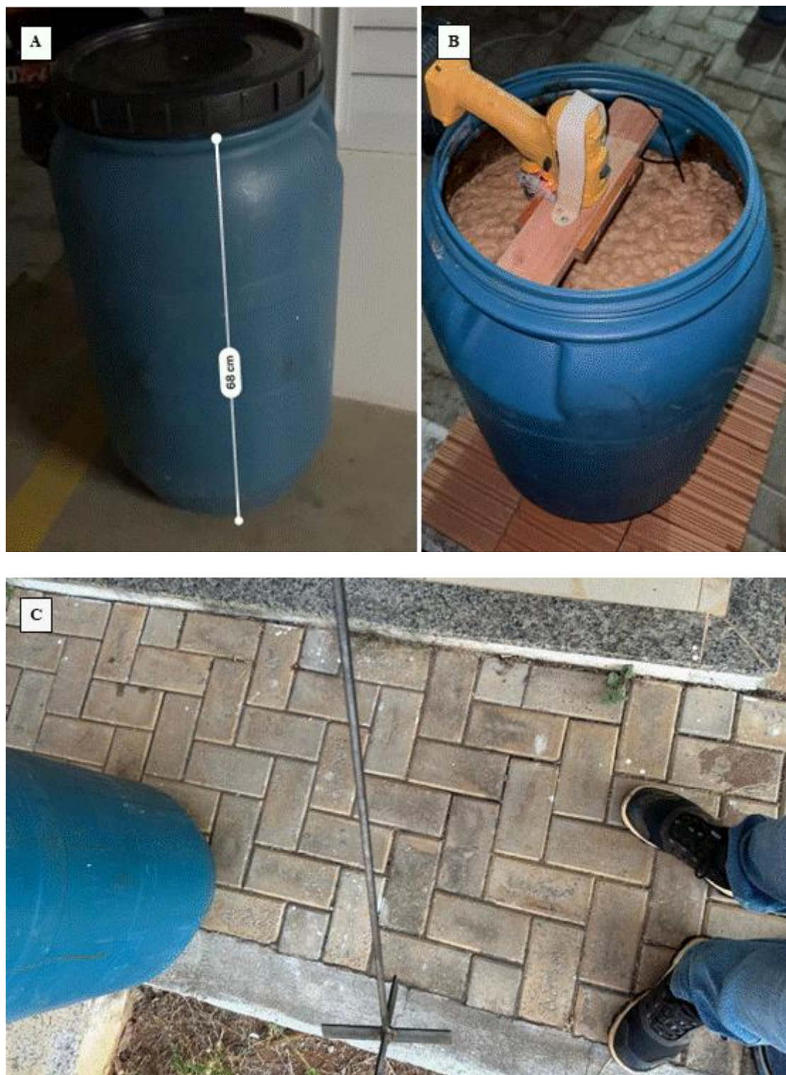
Figura 29 – Escala piloto. A – Bombona utilizada no ensaio de coagulação/floculação/sedimentação do lixiviado bruto. B – Dispositivo de mistura. C – Hélice usada na coagulação e floculação
