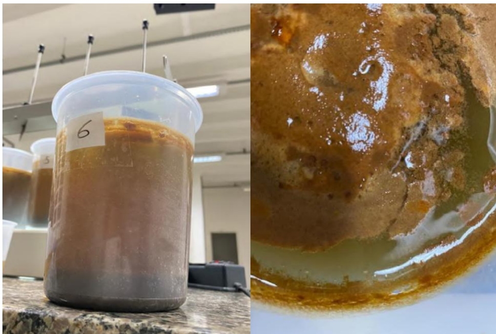
Figura 40 – Aparência do lixiviado após o tratamento com cloreto férrico (testes preliminares)
