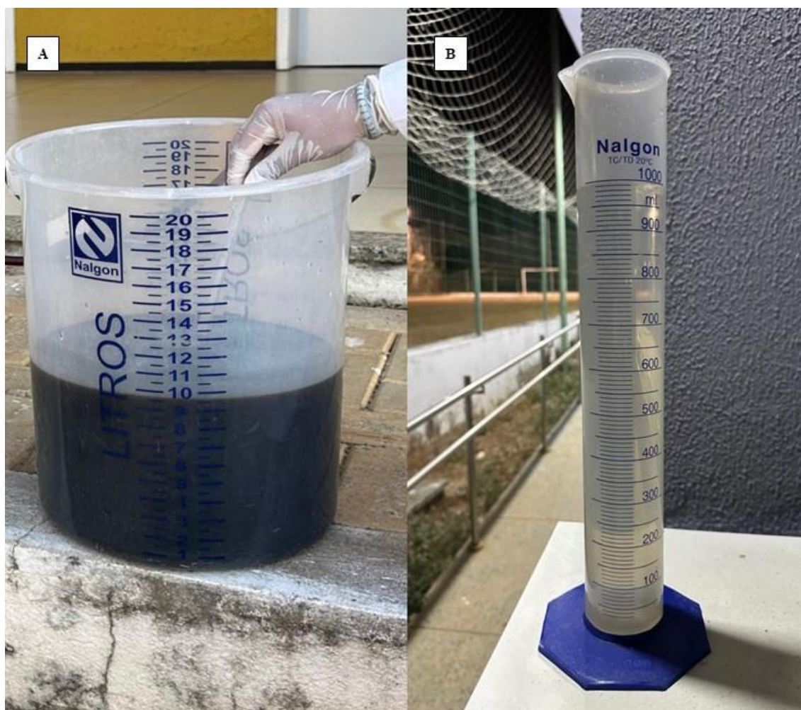
Figura 45 – Lixiviado bruto (A) e lixiviado tratado no destilador D1 (B)
