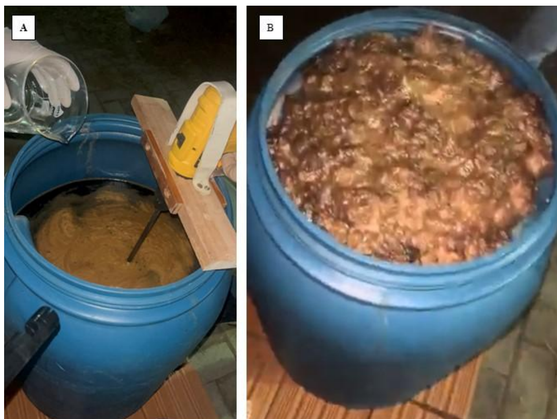
Figura 41 –Realização do pré-tratamento: inserção do ácido sulfúrico PA (A) e formação da espuma no lixiviado bruto (B)
