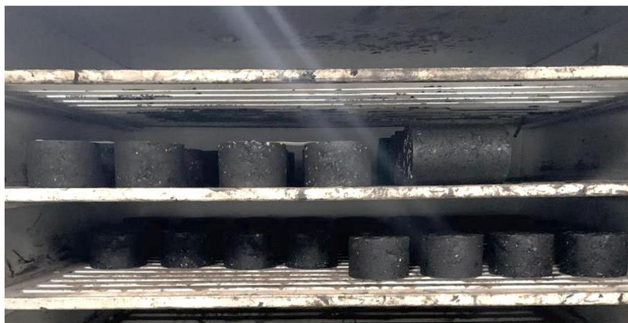
**Figura 34** - Corpos de prova acondicionados à temperatura ambiente após o envelhecimento
