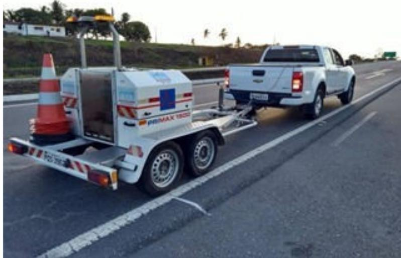
Este sistema tem a capacidade de ajustar o pulso de carga recebido pelo pavimento à forma de senoide mais aproximada possível. A força de pico é, então, obtida pela igualdade entre a energia potencial da massa, antes da queda, e o trabalho desenvolvido pelos amortecedores, depois da queda, resultando na Equação 13 a seguir, conforme Cardoso (1999):
