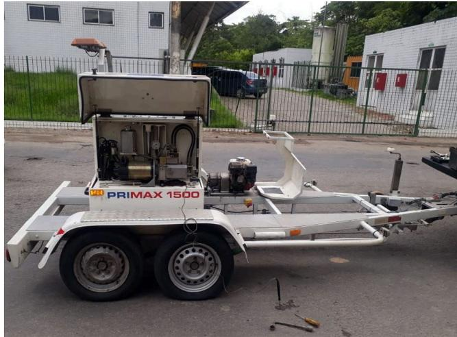
**Figura 47** - Esquema de funcionamento do equipamento FWD utilizado nesta pesquisa
