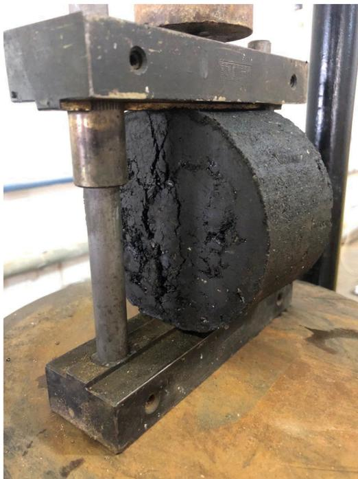
A aplicação de carga acontece progressivamente com uma velocidade de deformação de  $0,8 \pm 0,1$  mm/s até que se dê a ruptura por separação das duas metades do CP segundo o plano diametral de carga. Com a leitura realizada de força até a ruptura, é calculada a resistência máxima de tração da amostra, em MPa.
