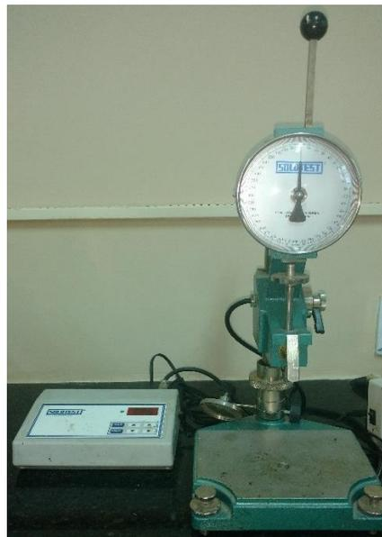
Inicialmente, a amostra foi levada à estufa para aquecimento, até obter uma consistência fluida; foi colocada em um recipiente cilíndrico, metálico e de base plana, cujos diâmetro e altura interna são respectivamente 55 e 35 mm, adequados às amostras com penetração até 200 décimos de milímetro; foi resfriada à temperatura ambiente e, em seguida, colocado em banho d'água.
