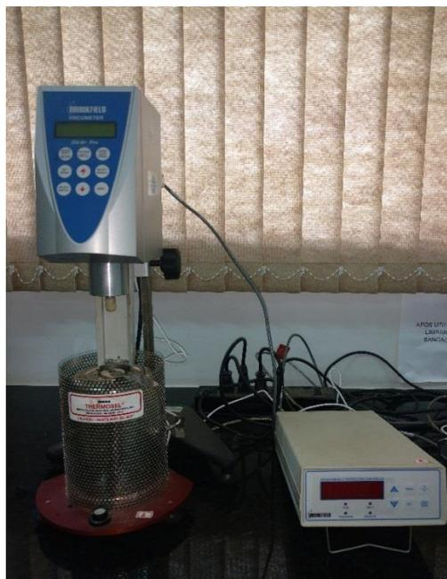
A viscosidade é medida, então, por meio do torque necessário para girar o spindle imerso na amostra de asfalto nas velocidades de 20, 50 e 100 rpm, respectivamente às temperaturas do ensaio supracitadas. Essa propriedade foi medida, antes e após o envelhecimento a curto prazo, em todas as amostras.
