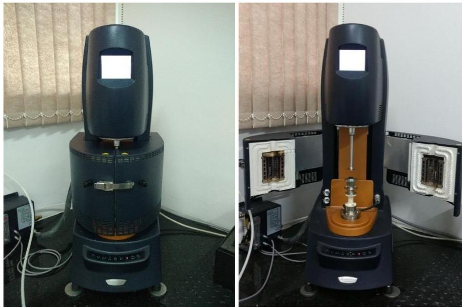
O procedimento para obtenção de tais parâmetros é o mesmo: é realizada uma varredura de temperaturas na faixa de 46 a 82° C, variando de 6 em 6° C, conforme estipula a ASTM D6373 – 15, numa frequência de 10 rad/s e deformação de 10% nas amostras, antes e após o envelhecimento RTFO.
