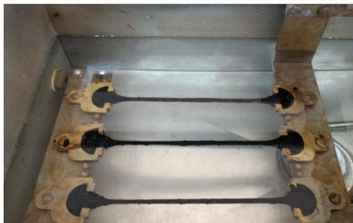
Cessada a tração, a amostra é seccionada ao meio e após 60 min pode ser observada a distância de retorno elástico. A recuperação elástica foi então obtida a partir da média de três resultados individuais das amostras submetidas ao ensaio, antes e após o envelhecimento a curto prazo, calculados pela Equação 8:
