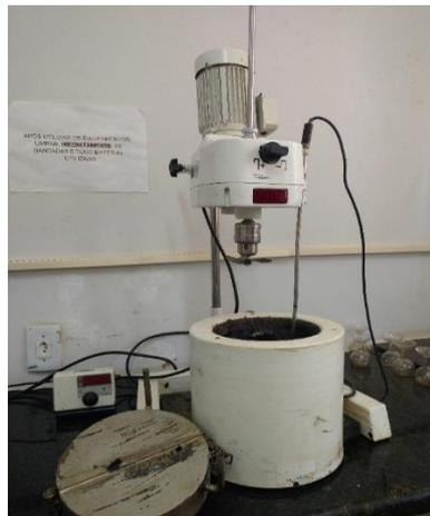
O CAP convencional foi aquecido até 160° C. Em seguida, adicionou-se para cada amostra a quantidade de lignina correspondente, mantendo-se constantes a temperatura e a rotação pré-definidas, por 30 minutos.
