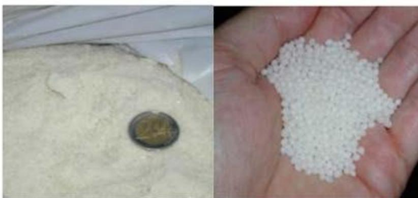
Os processos de mistura asfálticas com Sasobit<sup>®</sup> vem sendo realizados do mesmo modo que os de misturas convencionais, havendo somente a incorporação do produto na mistura e a redução da temperatura de usinagem. Sua adição pode ser feita tanto ao ligante antes da usinagem, quanto à mistura imediatamente antes da entrada do ligante ou em conjunto com este (PROWELL e HURLEY, 2007).
