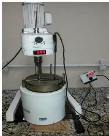
Para a inserção do aditivo no misturador com o CAP, manteve-se a tampa do misturador entreaberta, pois o CAP 50/70 à temperatura de 180 °C fica muito fluido e isto poderia causar respingos e prováveis acidentes, como queimaduras. A Figura 21 ilustra o modo como inserido o CCBIt no misturador.
