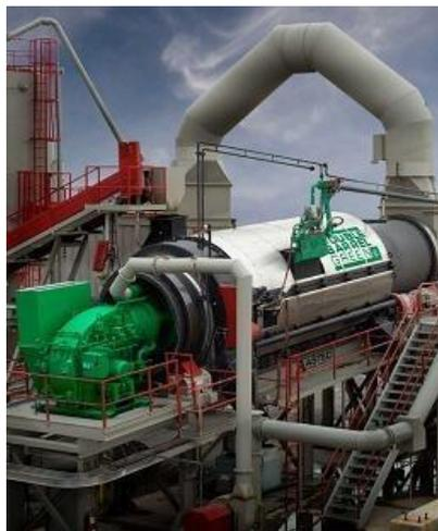
Normalmente, as misturas mornas no sistema Double Barrel<sup>®</sup> Green são usinadas entre 120 e 135°C e compactadas em até 115 a 110°C (MIDDLETON e FORFYLOW, 2009; D'ANGELO et al., 2008; PROWELL e HURLEY, 2007).
