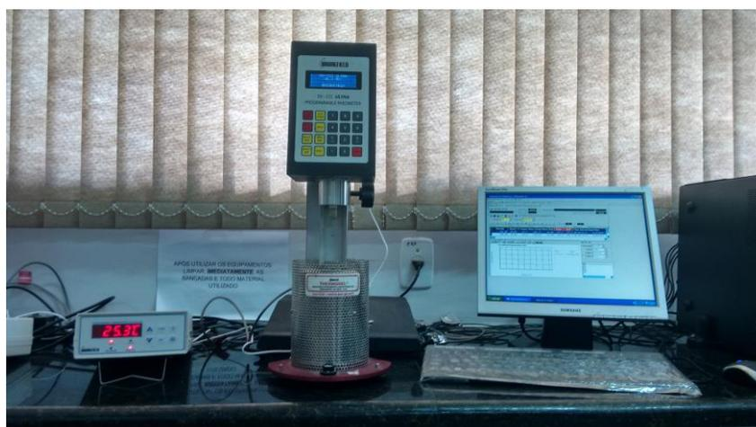
Figura 3.7 – Acessórios utilizados no para determinação da viscosidade Rotacional – Viscosímetro Brookfield do LEP/UFCG.
